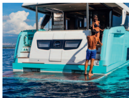
MANNKAPSLUGAR: Mannskapet har inngang til sin lugar fra badeplattformen som kan senkes. Har man en jolle her, blir den lett å sjøsette.
