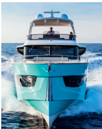
FEM METER BRED: En behagelig marsjfart er 18 knop. Da kan man nøye seg med 2x435 hestekrefter koblet til pod-drev.
