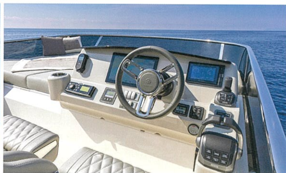
左:フォアデッキには、U字形のラウンジスペースが設けられている。左右のクッションのサイズは大きく、サンベツとしても活用することができる 中:フライブリッジのヘルムステーション。各種航海機器のパネルがコンパクトにまとまっている。右端にはボルボ・ペンタIPSのジョイスティックが見える 右:トランサム位置まで延びたフライブリッジには、広大なスペースが広がる。フォアデッキ、アフタデッキを含め、快適に過ごすために無駄なく空間が活用されている
