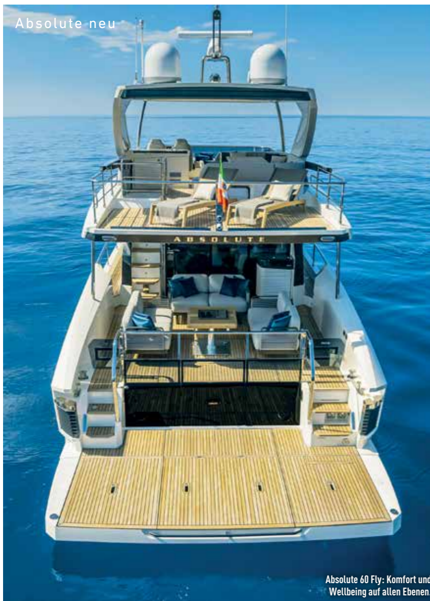
Flybridge mit Hardtop und elektrisch ausfahrbarem Sonnenschutz.
