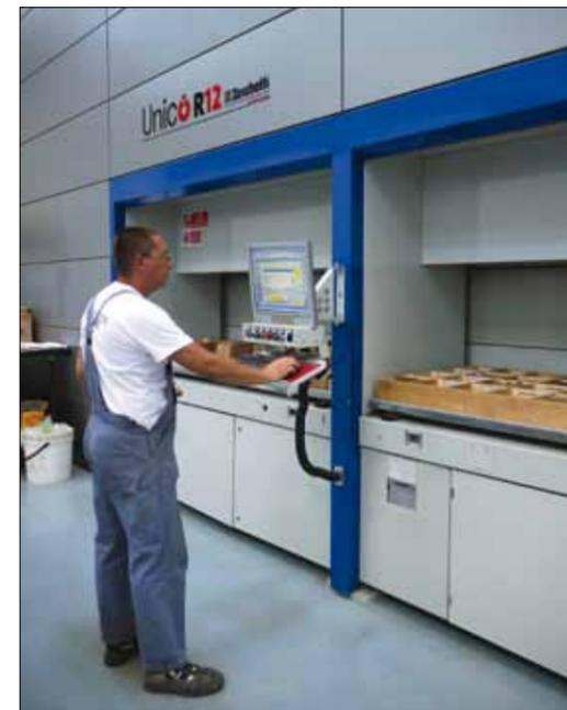
Une tour de stockage géante et robotisée permet une gestion fine de la disponibilité des pièces avant montage. Un opérateur pilote par ordinateur l'exécution automatique des commandes par les robots, qui vont s'approvisionner dans les stocks enfermés dans la tour.
