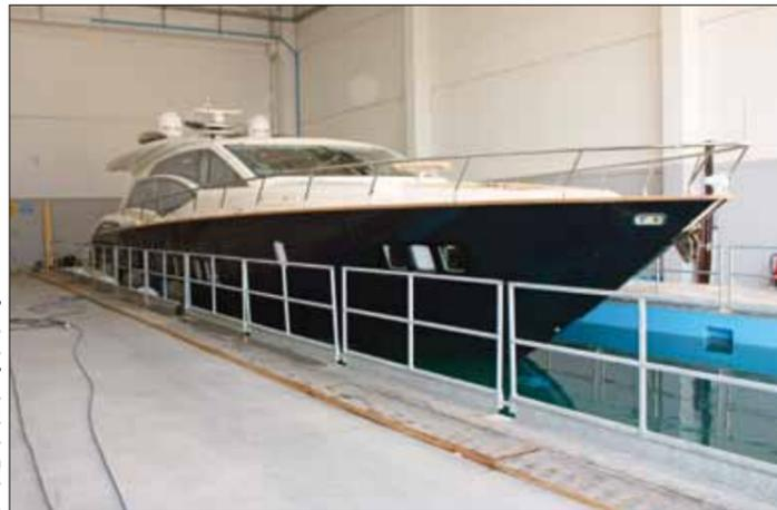
Avant de partir vers les bases d'essais d'Absolute sur la côte Ligure, les bateaux sont testés dans un bassin couvert intégré au chantier.
